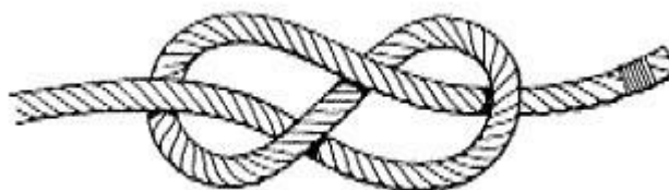
Figuur 3-4, "Figure 8" Knot (achtknoop)
