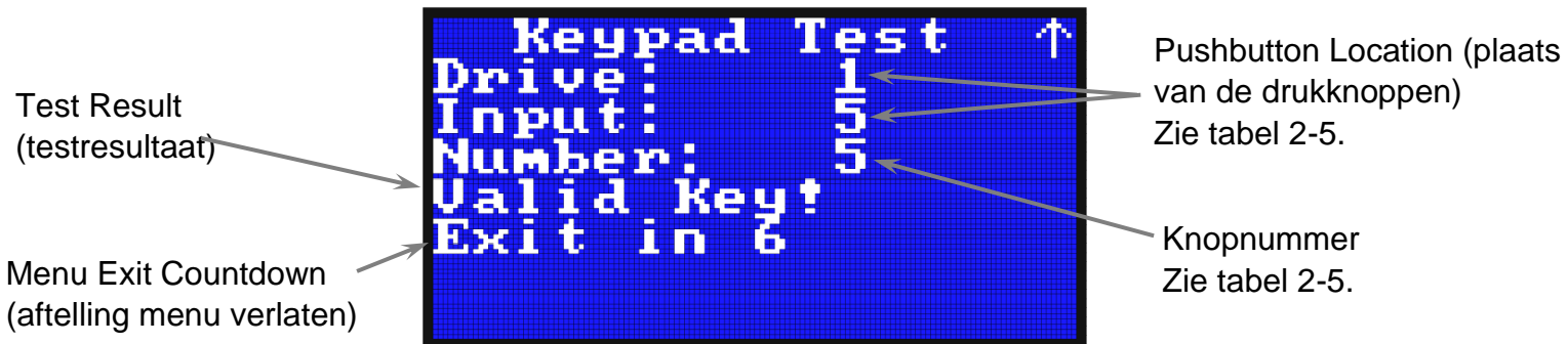
Figuur 2-54, Display - Keypad Test Screen (testscherm knoppenpaneel)
