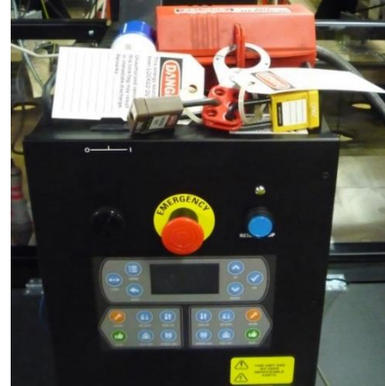
Figuur A-2, Multiple Operator LOTO (LOTO enkele medewerker)
